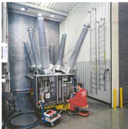
Prueba de rutina de un 3AP1 DT 245 kV
